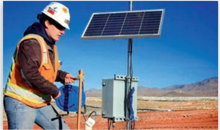
Karla Peabody, una profesional en metalurgia en las operaciones de Safford en Arizona, posee un piezómetro en el lecho de lixiviación de la Fase I. Los piezómetros brindan datos de nivel de solución en tiempo real a los profesionales en metalurgia que monitorean la integridad estructural de los lechos de lixiviación para garantizar una producción segura de cobre.
