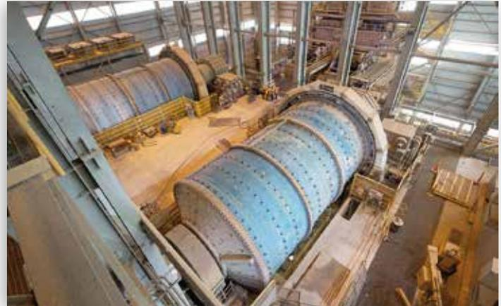
Perluasan pabrik pengolahan Morenci di Arizona dimulai pada Mei 2014. Proyek ini termasuk pemasangan mesin-mesin *ball mill* dengan efisiensi tinggi, serta sebuah *hydraulic roll crusher* yang memungkinkan pengolahan volume bijih lebih besar dengan efisiensi energi yang 25 persen lebih tinggi dibanding yang lazim berlaku di industri ini.
